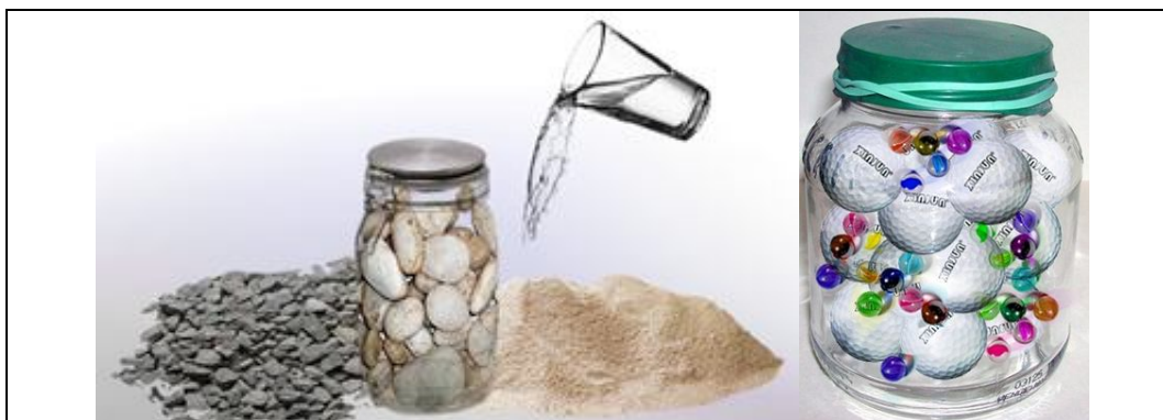
Figura 1. Efecto del llenado de huecos empleando partículas (material de construcción o bolas de colores) de distintos tamaños.
