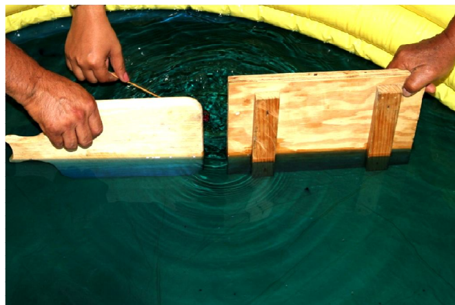
Figura 13. Fenómeno de difracción observado en una experiencia con ondas en agua.
