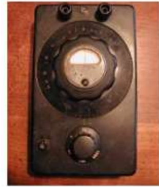
Figura 2.- Imagen de un Puente de Wheatstone típico
